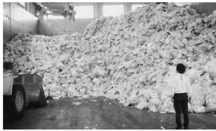
▲プラスチック製容器包装中間処理施設では収集した物を選別・圧縮しリサイクル工場へ搬送します。
