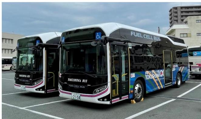
資料：水素燃料を用いて走行する燃料電池バス(徳島バス HP)
