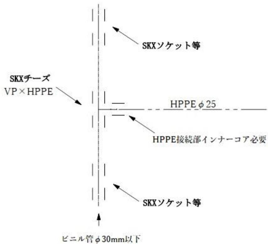
図 6-2 ビニル管  $\phi 30\text{mm}$  以下から分岐
