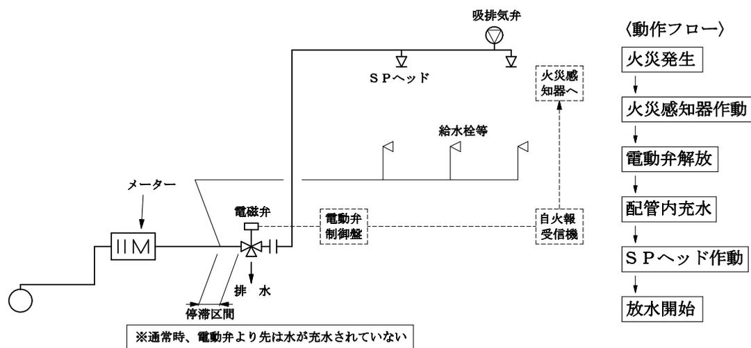
図 6-35 乾式スプリンクラー配管例
