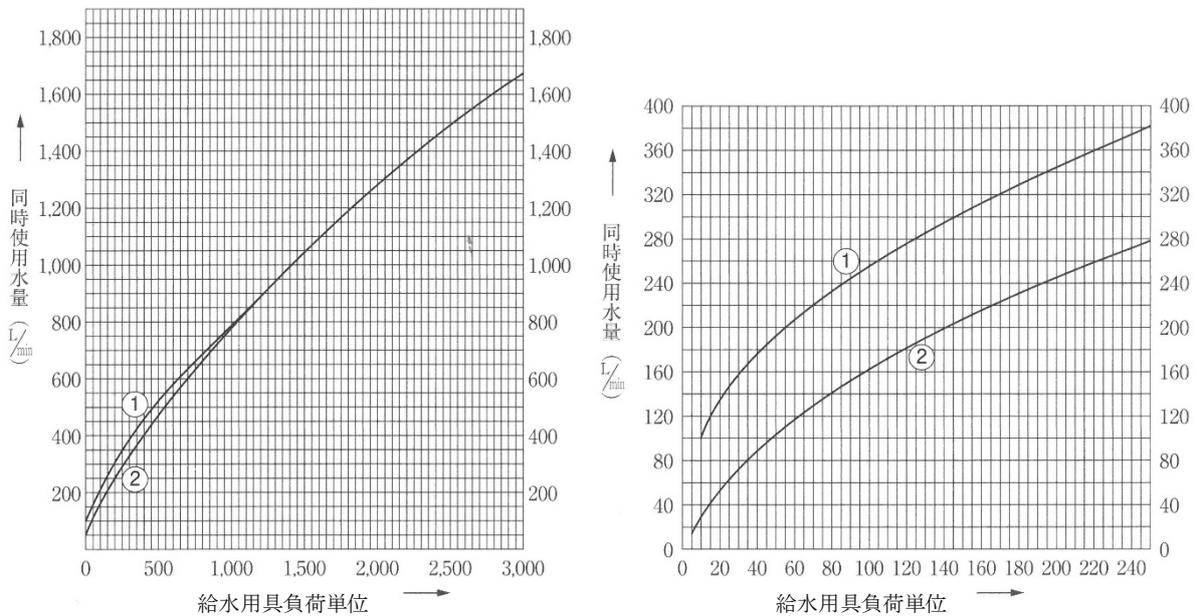
注：曲線①は大便秘器で洗浄弁の多い場合、曲線②は大便秘器で洗浄タンクの多い場合に用いる。
