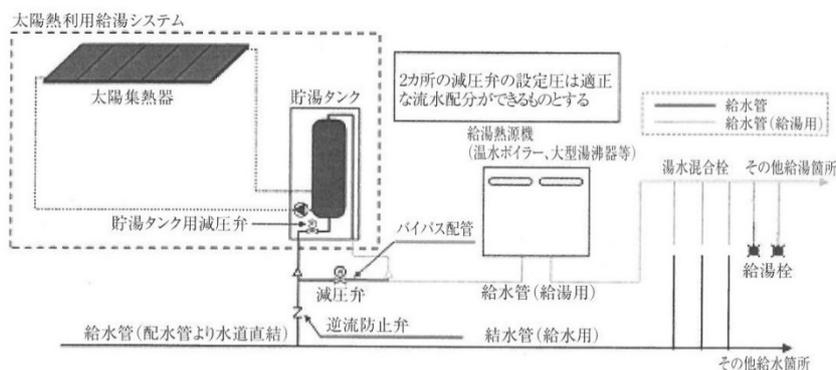
図 6-36 太陽熱利用給湯システム設置例
