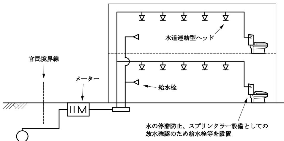
図 6-34 湿式スプリンクラー配管例
