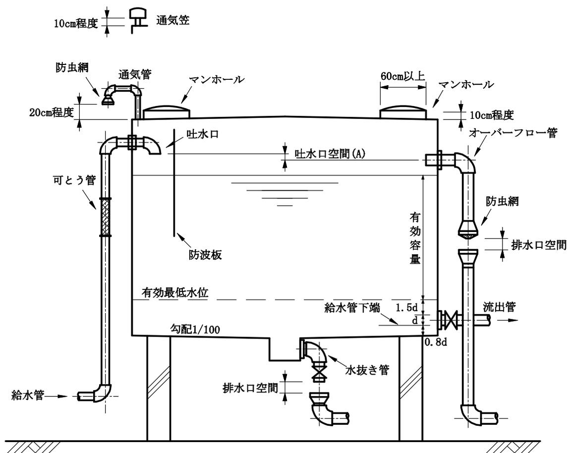
図 7-4 受水槽標準構造図
