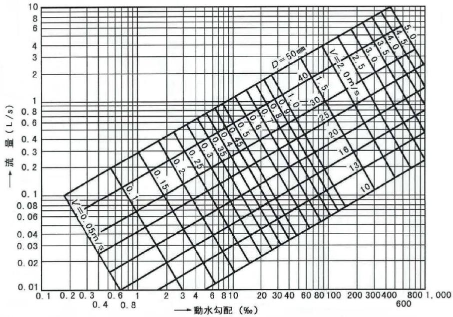
図 5-9 ウェストン公式による流量図
