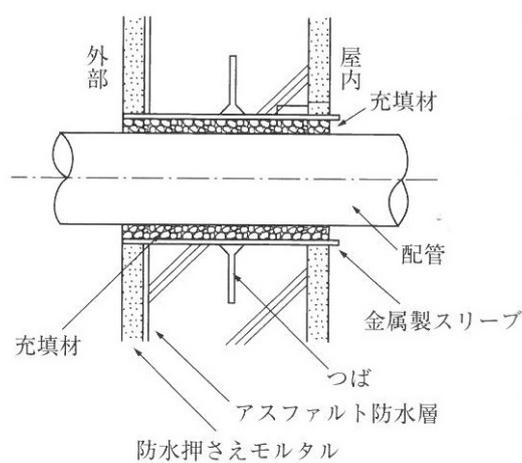
図 8-6 配管スリーブの設置
