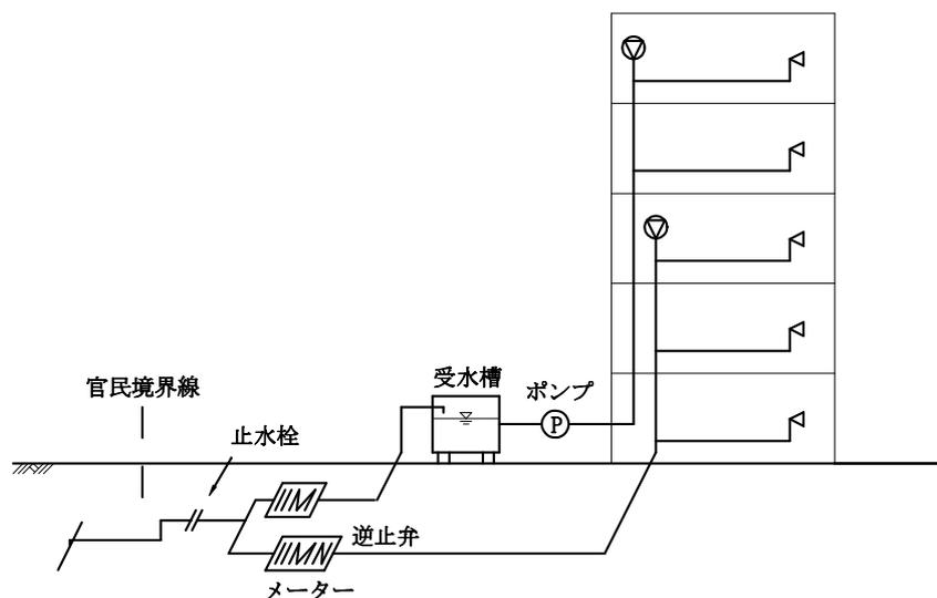
図 5-5 直結・受水槽併用式
