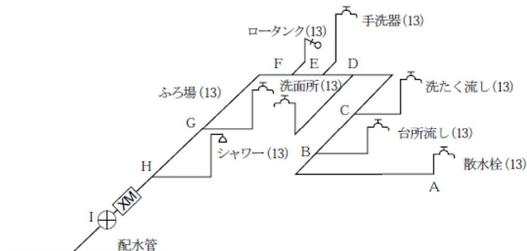
給水幹線より各器具に分岐する支管の口径は、それぞれ取付器具の口径と同口径を使用するものとする。
