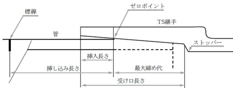
TS継手の接合
