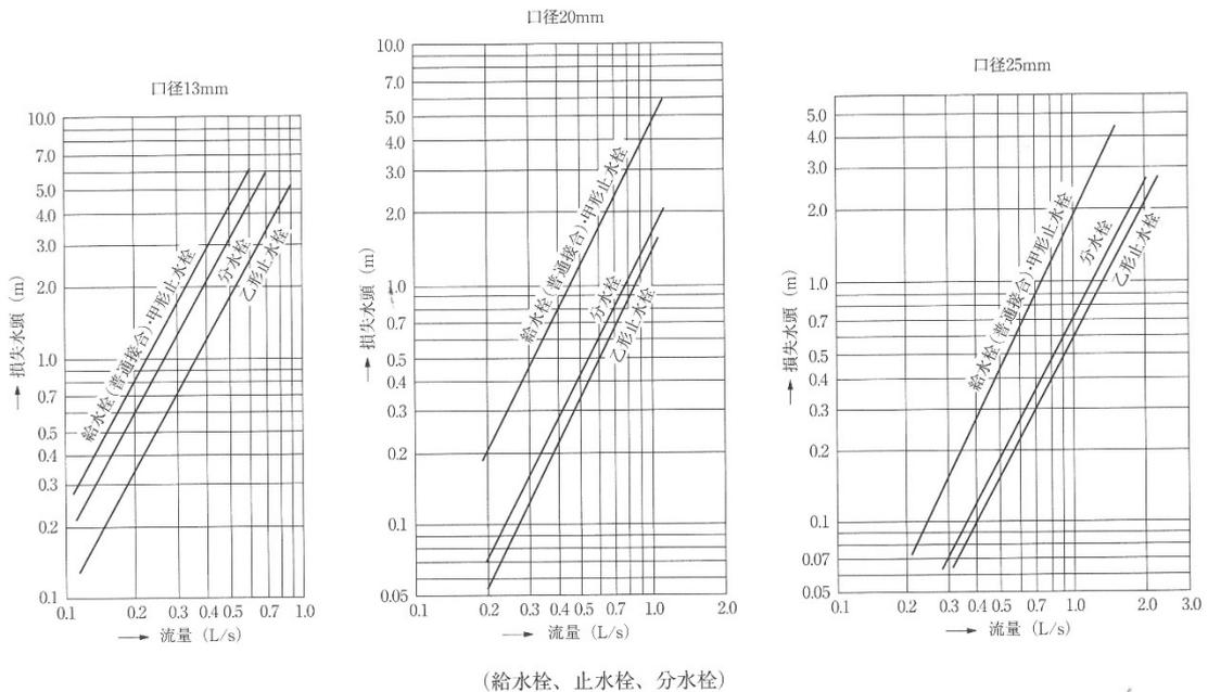
(a) 水栓類 (給水栓、止水栓、分水栓)
