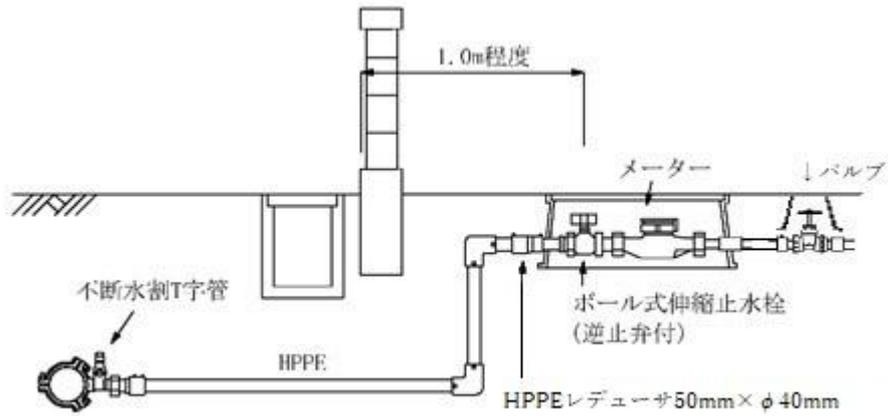
図 6-4 給水管取出し標準図 (φ 40mm 設置例)
