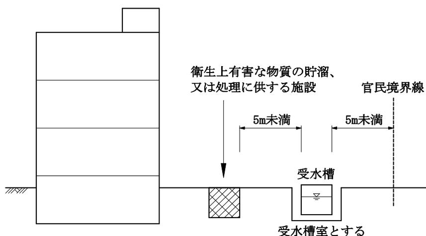
外部から受水槽等の天井、底、又は周壁の保守点検が容易にできるように設ける。したがって、受水槽室を設け、その中に受水槽等を設置する必要がある。
