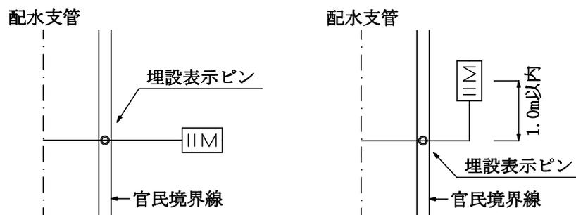
図 6-37 埋設表示ピンの設置例
