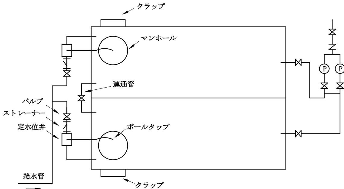
図 7-5 受水槽の平面図 (2 槽式)
