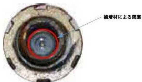
図2 スプリンクラーヘッドの内部で固着した接着剤(白色部分)
