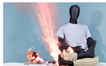
充電式掃除機の バッテリー発火事故の再現
