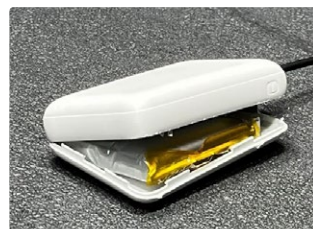
膨張した モバイルバッテリー
