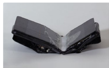
外部からの力により発火・ 燃焼したスマートフォン
