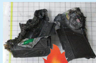
▼出火し焼け焦げた小型充電式電池
